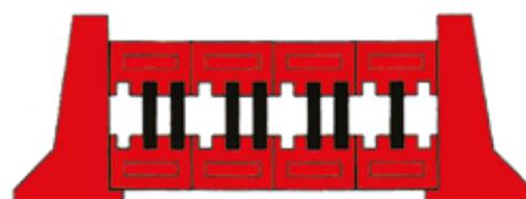
Costruiti in policarbonato rinforzato con fibra di vetro per alte temperature (120°C), colore rosso RAL3002, ESENTI da ALOGENI, AUTOESTINGUENTI, i blocchetti "MULTIBAR" vengono fissati a robuste guide di supporto (2264) e, disponibili in 4 diverse versioni, rappresentano la soluzione ai più diversi problemi di supporto sbarre.
